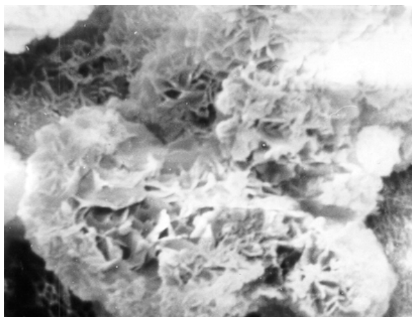
Obr.3. Častice periklasu a platničkovitého klencovitého magnezitu zachyteného zo šachtových pecí, zväčš. 500 x. Obr.4. Dekarbonizovaná častica magnezitu, zväčš. 2000 x.
