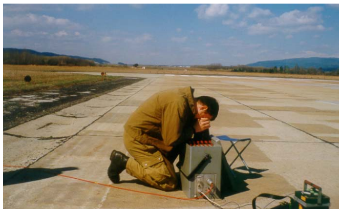
Obr.5. Meranie na pristávacom úseku VDP letiska Poprad seizmickou aparátúrou Bison Instruments 1580.
