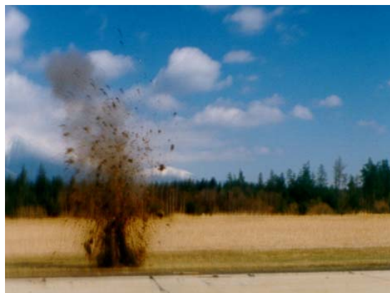
Obr.7. Zdrojom seizmických vln bol výbuch malých náloží trhaviny pozdĺž letiskovej dráhy.
