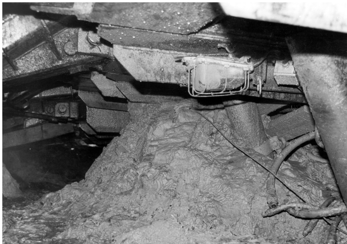
Foto.1 Průval zvodnělých hornin do stěnového porubu.
