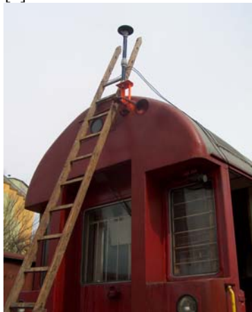
Obr. 2. Experimentálne kontinuálne meranie tvaru koľaje. Fig. 2. Experimental continual measurement of the rail shape
