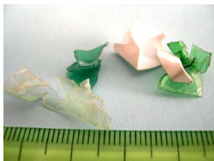
Obr. 1. Tvar zle flotovateľných častíc plastov podrvených na priemyselnom drviči plastov DP 15
