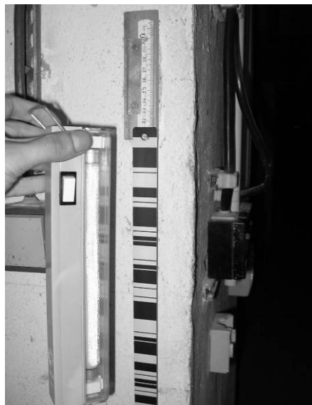
Obr. 4. Invarová závěsná stupnice Zeiss BD 05 s osvětlením. Fig. 4. Suspended invar scale Zeiss BD 05 with an illumination..
