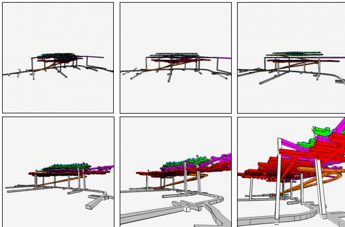
Obr. 3. 3D simulácia – virtuálny „prelet“ komplexom banských diel. Fig. 3. 3D simulation – a virtual “flyby” over a complex of the mining drifts.
