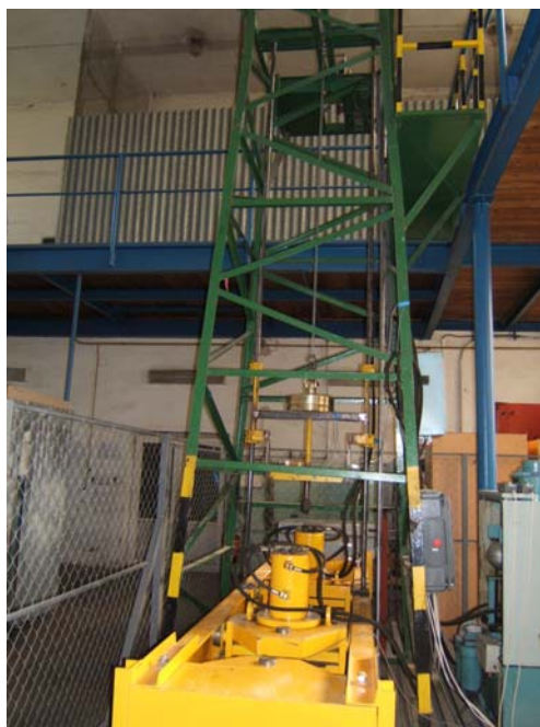
Obr. 1. Skúšobné zariadenie na testovanie odolnosti dopravných pásov proti prierazu. Fig. 1. Experimental stand for testing of conveyor belts breakdown resistance.
