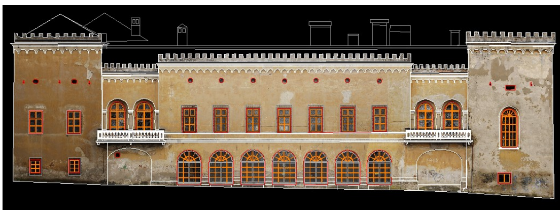
Obr. 7. Fotoplán v impozícii s vektorovou kresbou. Fig. 7. Photo-plan in imposition with vector draw.
