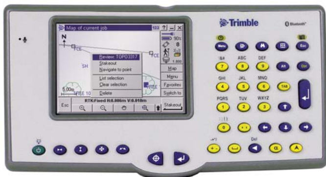
Obr. 2. Prenosná a odnímateľná kontrolná jednotka (poľný počítač) ACU pre GPS RTK/PP totálne stanice modelov 5700/R7/5800/R8.
