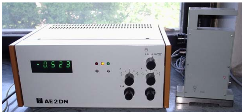
Obr. 2 Vstupno-výstupná jednotka AE 2 DN a snímač naklonenia Libela 2800
