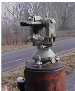
Obr. 4. Prístroj WILD T3 Fig. 4. WILD T3 instrument
