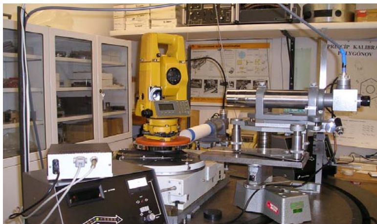
Obr. 5. Kalibrácia prístroja Topcon GTS 6B na EZB - 3
