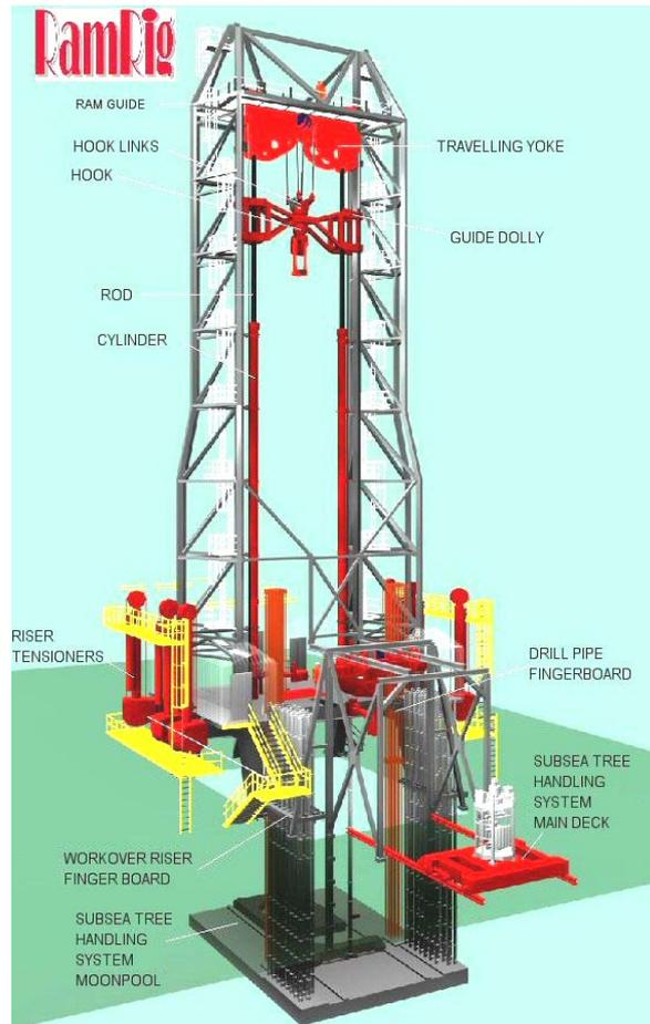
Fig. 2. RamRig<sup>®</sup> new rig offshore concept.
