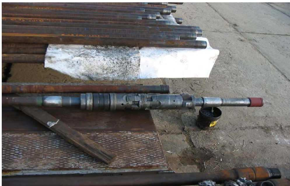
Obr. 2. Pakr s No-Go vsuvkou před zapuštěním do sondy (foto autor). Fig. 2. Packer with the landing nipple.
