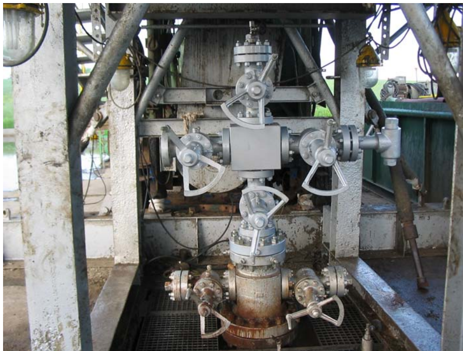
Obr. 1. Produkční kříž Jt 21 MPa 3 x2 po montáži na ústí sondy (foto autor).
