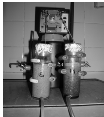
Obr. 2. Biolúhovanie vzoriek v perkoláčnych kolónach. Fig. 2. Bioreaching of the samples in percolated columns.
