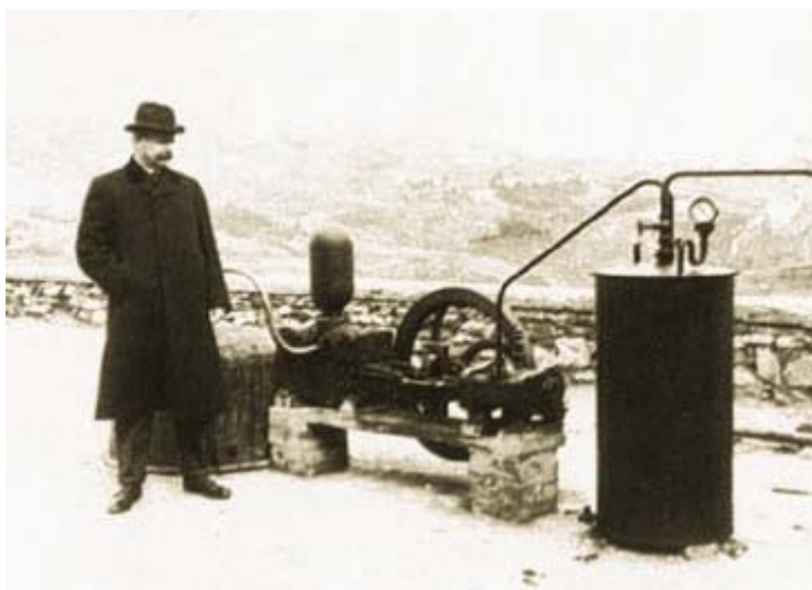
Obr. 3. Parný stroj použitý v Lardarello v roku 1904 pri prvom experimente výroby elektrickej energie z geotermálnej pary (na obrázku s vynálezcom princom Piero Giori Conti) [9] Fig. 3. The steam engine used at Larderello in 1904 in the first experiment in generating the electric energy from a geothermal steam, with its inventor, Prince Piero Giori Conti [9]
