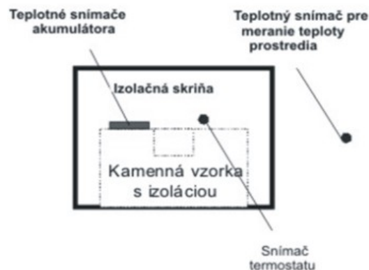
Obr. 8. Rozmiestnenie teplotných snímačov v priebehu merania tepelného toku. Fig. 8. The location of heat sensors in the course of the heat flow measurement.
