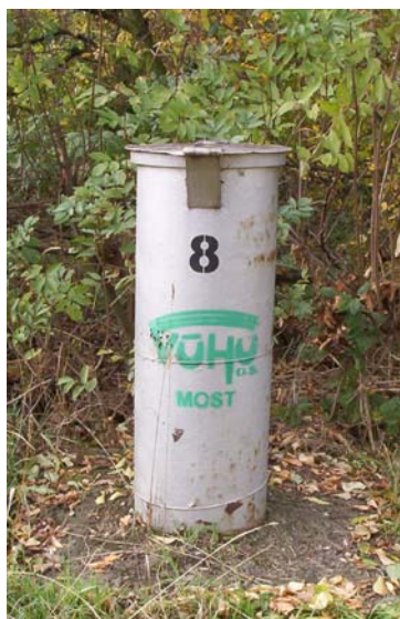
Obr. 2. Český státní etalon velkých délek - pilíř nucené centrace.
