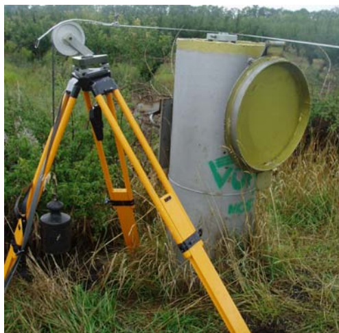
Obr. 5. Český státní etalon velkých délek - měření invarovými pásmy.
