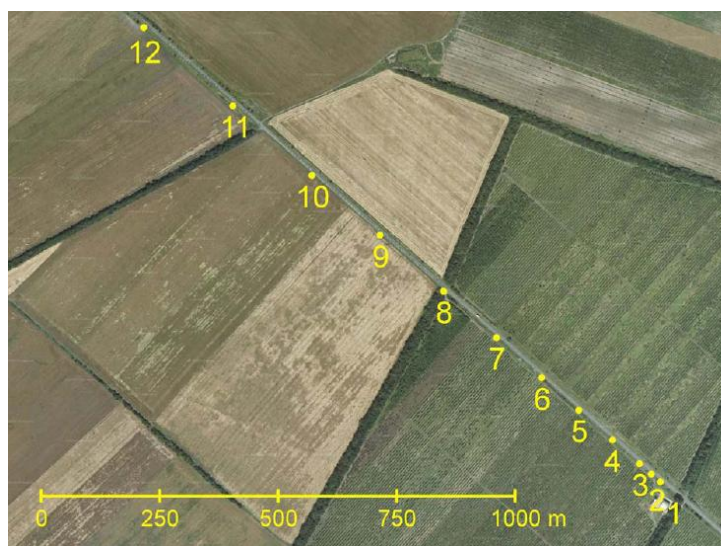
Obr. 1. Český státní etalon velkých délek - rozmístění pilířů.
